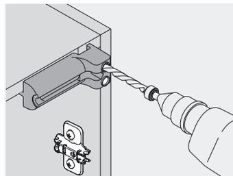
Bohrung für BLUMOTION mit Bohrer Ø 10 mm anbringen
